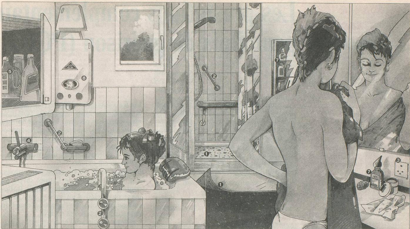
leux, et on ferme toutes les fenêtres. Or, il faut une aération suffisante. Une hotte est indispensable dans les locaux de moins de 60 m<sup>3</sup>. Un chauffe-bain doit être contrôlé une fois par an et ne doit jamais être bricolé. A la moindre odeur, ouvrez portes et fenêtres après avoir fermé le robinet. Appelez le spécialiste s'il y a des traces noires au plafond, une flamme irrégulière, des odeurs. Si vous vous occupez d'une personnes très âgée, prenez ces précautions pour elles.
