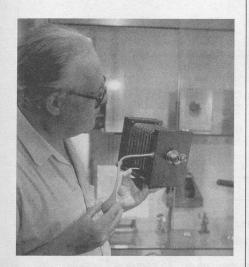
Un ancêtre: chambre à soufflet, objectif enchâssé dans du laiton et obturateur à poire de caoutchouc.
