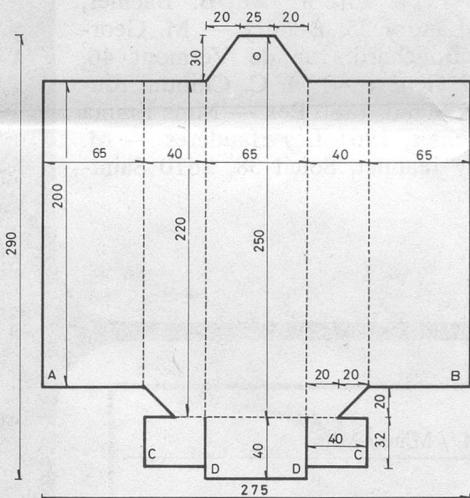
Reproduire sur un carton gris, assez fort, le dessin ci-contre (les dimensions indiquées sont en millimètres). Découper en suivant les traits continus et plier selon les pointillés. Après pliage, le volet A viendra collé sur le volet B et les deux languettes C sur la partie D, à l'extérieur !
