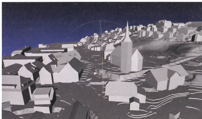
Abb. 2: Ausschnitt aus dem Stadtmodell Steffisburg, vorwiegend mit Laserscanning hergestellt.
