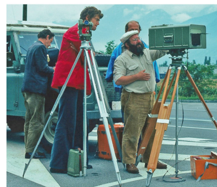
Abb. 7: EDM mit AGA Geodimeter 8 des IGP 1975 mit W. Schneibel (Operateur) und W. Fischer, Projektleiter (I.) (Foto: S. Heggli).
