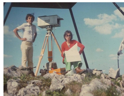
Abb. 9: EDM der L+T auf TP 1. Ord. Suchet VD mit Geodimeter 8, 1976; Operateur: A. Carosio (Foto: A. Carosio).
