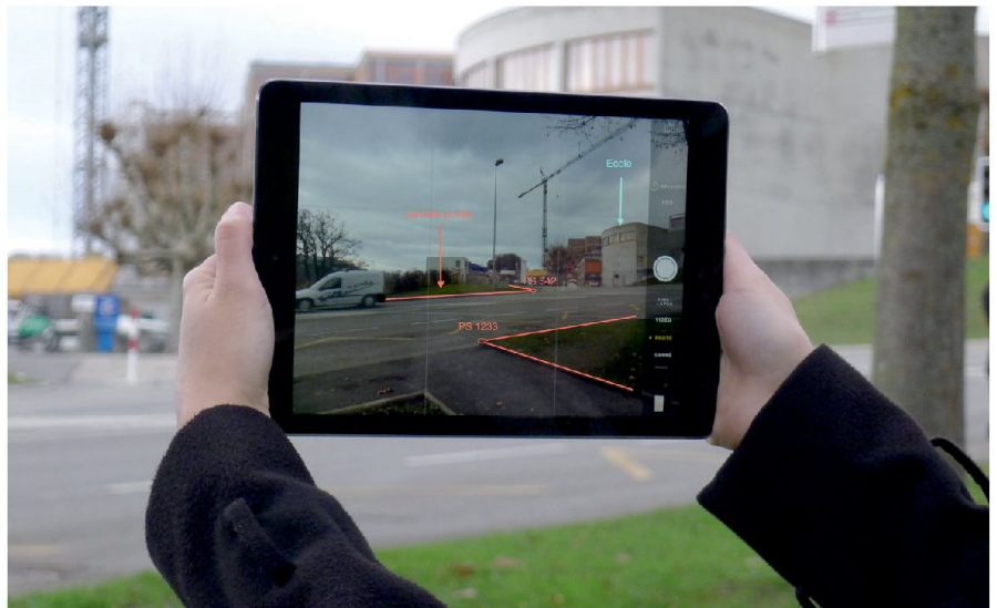
Fig. 1: Un exemple de réalité augmentée avec les données de la mensuration officielle.
