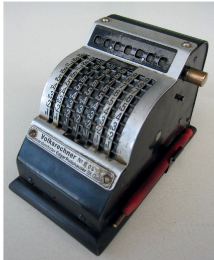
Abb. 3: Der Volksrechner mit Einstellwerk (unten) und Eingabestift sowie Ergebniswerk (oben) mit Löschkurbel (ohne Griff).
