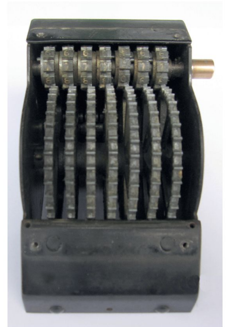
Abb. 4: Ein Blick ins Innere des Volksrechners zeigt die Zahnräder des Einstellwerks (unten) und des Ergebniswerks (oben).
