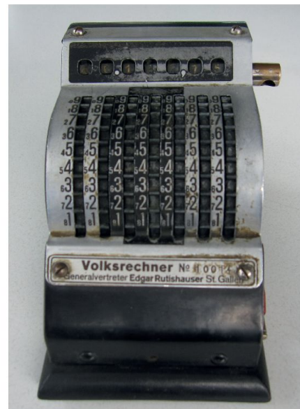
Abb. 1: Stellradgriffeladdierer mit Subtraktion und automatischem Zehnerübertrag namens «Volksrechner» aus St. Gallen bzw. Berlin aus den 1930er Jahren. Bei der Löschkurbel fehlt der Griff. Zu beachten: Die grossen Ziffern dienen für die Addition, die kleinen Ziffern (Komplementärwerte) für die Subtraktion (alle Bilder © Bruderer Informatik 2014).
