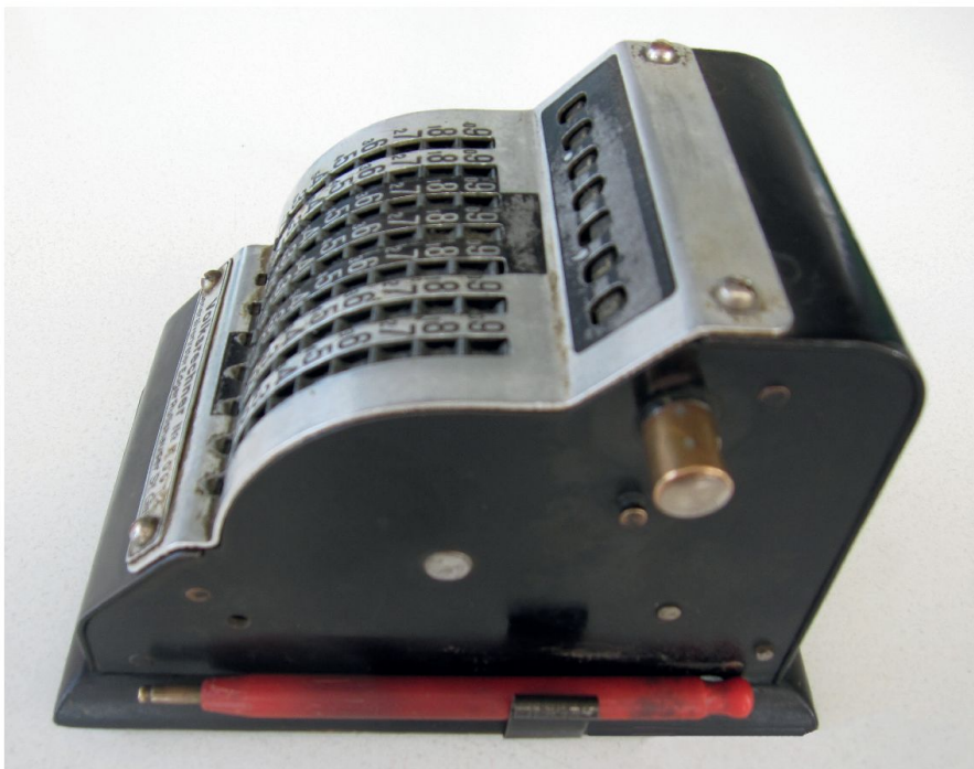
Abb. 2: Volksrechner. Seitenansicht mit Stift für das Zahnradgetriebe (Eingabe der Zahlen) und Löschkurbel fürs Ergebniswerk (Griff fehlt).
