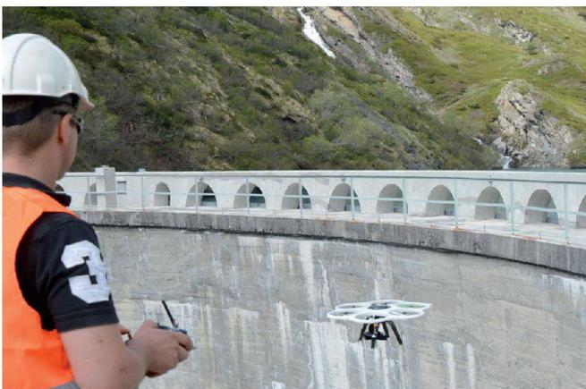
Der Aibotix X6, ein leichter, unbemannter Multikopter, ergänzt auf ideale Weise die Luftbildlösungen von Leica Geosystems. Das System bietet deutliche Vorteile bei der sicheren 3D-Datenerfassung und der Inspektion von unzugänglichen Infrastrukturen wie Stromleitungen, Brücken, Staudämmen und Kraftwerken. Sehen Sie hier ein Anwendungsbeispiel: [www.youtube.com/watch?v=wkbWEMq\\_cOg](http://www.youtube.com/watch?v=wkbWEMq_cOg)
