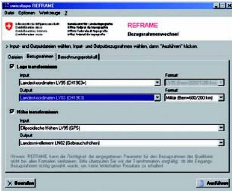
Abb. 4a: Benutzeroberfläche der neuen Transformationssoftware REFRAME, mit welcher neben der Transformation LV03  $\rightleftharpoons$  LV95 auch die Geoidundulationen (CHGeo98 und 2004) und die Differenz LN02  $\rightleftharpoons$  LHN95 (HTRANS: Verzerrungen der Gebrauchshöhen LN02 / unterschiedliche Höhensysteme) berechnet werden können. Zudem können die Schweizer Landeskoordinaten in globale Bezugssysteme wie ETRS89 oder auch in WGS84 umgerechnet werden.
