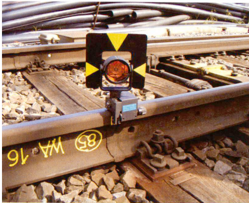
Abb. 3: «Specht» zur Versicherung von Absteckungselementen an die Schienenkante.
