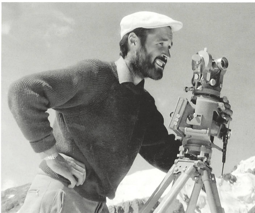
Abb. 1: Ernst Spiess bei stereofotogrammetrischen Aufnahmen mit dem Fototheodoliten im Panta-Gebiet, Peru, 1959. (Foto: E. Spiess)
