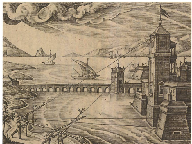
Abb. 2: Bestimmung der Höhe eines Turms mit einem Triangularinstrument. Quelle: Benjamin Bramer: Apollonius Cattus, 3. Teil (10. Kapitel).
