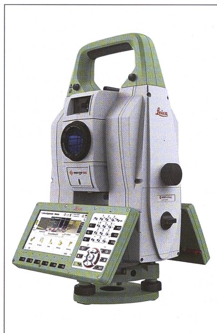
Abb. 13: Multifunktional: Die Multistation MS60 von Leica Geosystems Heerbrugg kombiniert Heinrich Wilds Theodolit-Aufbau mit aus Einsteins Theorie entwickeltem Laser zweifach: einmal zur Streckenmessung wie bei einer Totalstation und darüber hinaus mit einer LaserScan-Funktion zur Erfassung, Messung, Auswertung und Dokumentation von millimetergenauen 3-D-Laserpunktwolken.
