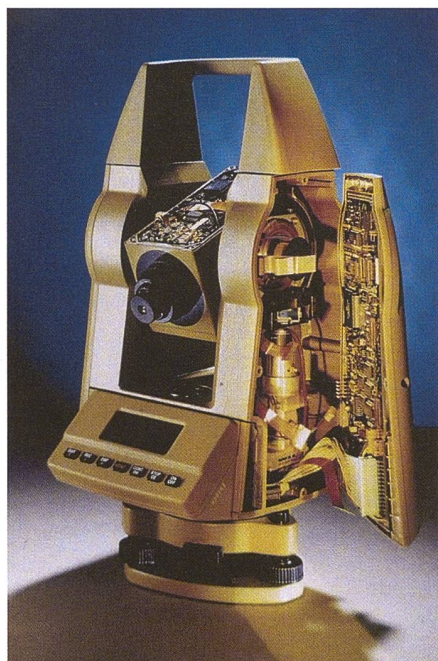
Abb. 6: Vereint: Einblick in elektronischen Tachymeter (Totalstation) des Jahres 1998 aus Heerbrugg mit Wild Konstruktionsaufbau für Winkelmessung sowie integriertem Laser-Distanzmesser, basierend auf Einstein-Theorie (Leica TC500).
