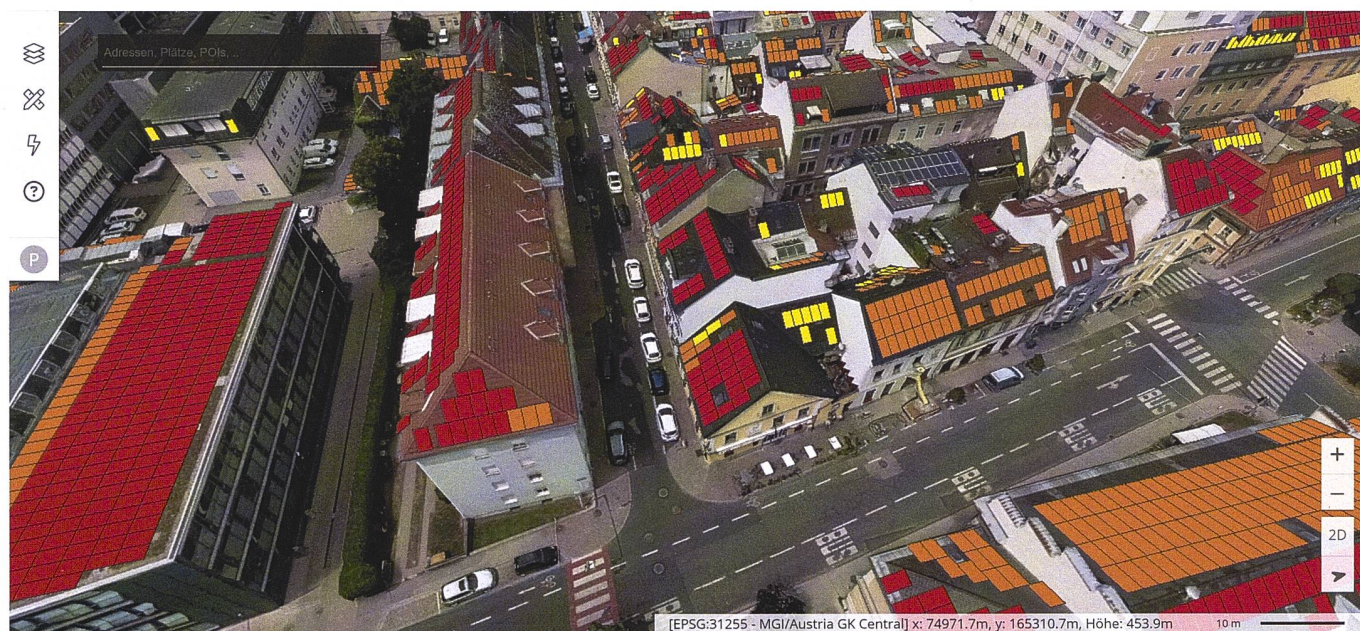
Abb. 4: Digitaler Zwilling der Stadt Klagenfurt, dargestellt ist das Solarpotenzialkataster. Die farbliche Darstellung stellt die Höhe des zu erwartenden Energieertrages dar (rot/orange/gelb).
