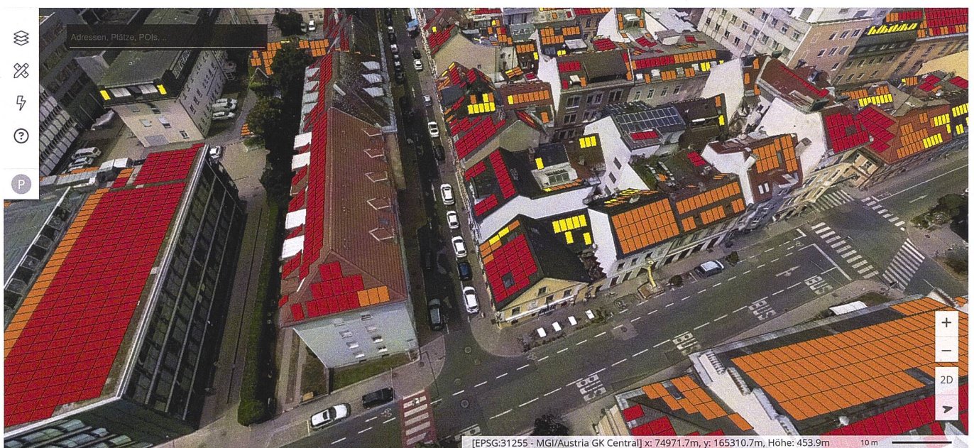
Abb. 4: Digitaler Zwilling der Stadt Klagenfurt, dargestellt ist das Solarpotenzialkataster. Die farbliche Darstellung stellt die Höhe des zu erwartenden Energieertrages dar (rot/orange/gelb).
