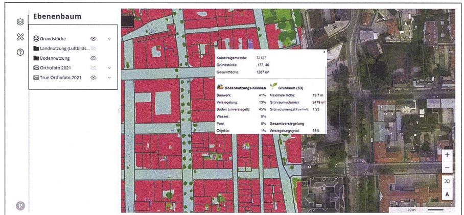
Abb. 3: Digitaler Zwilling der Stadt Klagenfurt. Bodennutzung, True Orthophoto und Versiegelung pro Parzelle.
