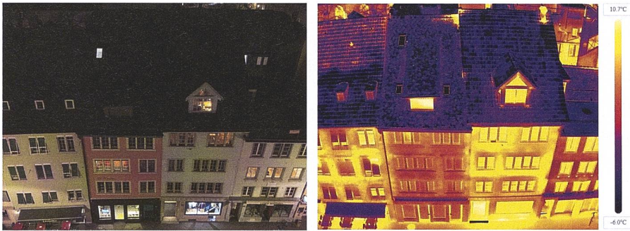
Abb. 1: Beispiel für RGB- und TIR-Bild einer Nachtbefliegung in Winterthur mit einer DJI M3T-Drohne, im Rahmen des Projektes ThermoPlaner3D ( https://www.thermoplaner3d.ch ).
