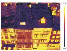
Abb. 1: Beispiel für RGB- und TIR-Bild einer Nachtbefliegung in Winterthur mit einer DJI M3T-Drohne, im Rahmen des Projektes ThermoPlaner3D (https://www.thermoplaner3d.ch).
