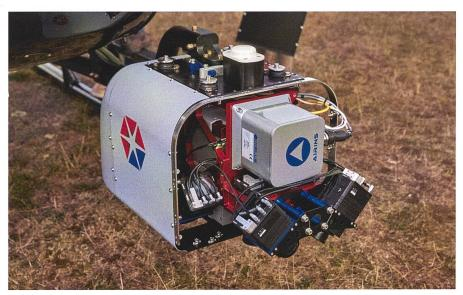
Abb. 2: Hexacam-Sensor zur Erfassung von LiDAR-Daten und Bildern in Nadir (RGB-NIR) und Schräglage mit sehr hoher Auflösung.
