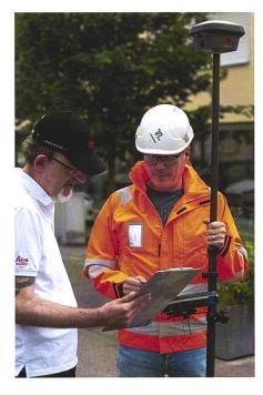
erfassen und zu messen, erfüllte die strengen Präzisionsanforderungen für die amtliche Vermessung und wurde vom Vermessungsamt des Kantons Aargau in der Schweiz bewilligt; und somit ist die photogrammetrische Genauigkeit und Zuverlässigkeit des Systems bestätigt. «Unter dem Strich ist man schneller, wenn man mit dem GS18 I fehlende Gebäudeecken erfassen kann», so Bruno Häusermann im Interview.
