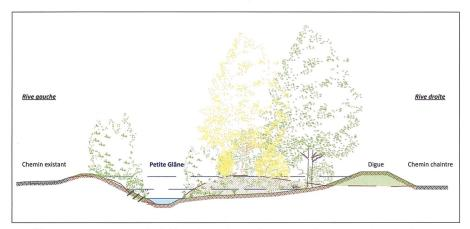
Profil en travers type de l'élargissement du cours d'eau en rive droite, avec défrichement, recul de la digue de protection et plantations (© CSD Ingénieurs SA).
