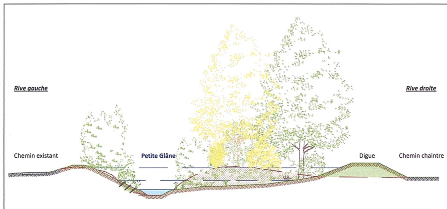
Profil en travers type de l'élargissement du cours d'eau en rive droite, avec défrichement, recul de la digue de protection et plantations (© CSD Ingénieurs SA).
