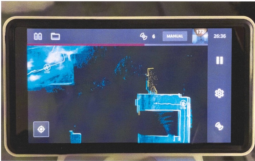
Abb. 2: Tablet des NavVis VLX 3.0 während dem Scanvorgang.
