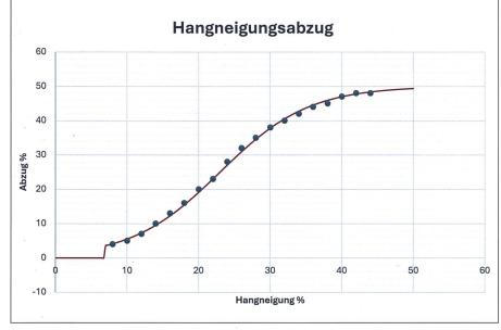
Abb. 3: Funktion zur Ermittlung der Hangneigung.
