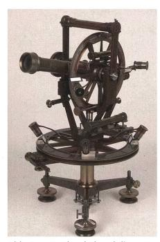
Abb. 4: «Gotthard-Theodolit», Bestimmung der Gotthard-Tunnel Achse, 1874 (swisstopo Bild 9287, 2013).
