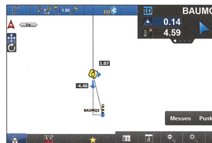
Fig. 2: Vue d'implantation GNSS Leica. Abb. 2: Absteckungsansicht Leica.
