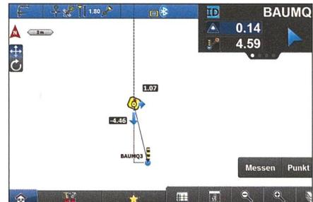
Fig. 2: Vue d'implantation GNSS Leica.
