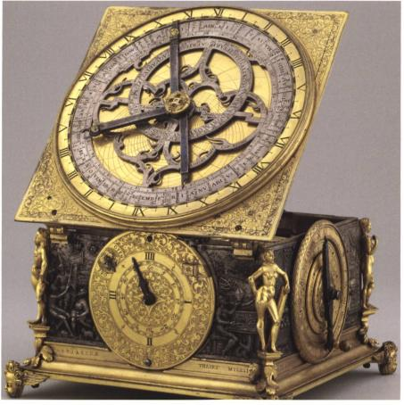
Abb. 5: Äquationsuhr mit aufgeklapptem Deckel (1591). Die komplexe astronomische Stutzuhr des Uhrmachers Jost Burgi zeigt die Differenz zwischen den mittleren und den wahren Bewegungen von Sonne und Mond an (sogenannte Gleichung, Äquation), © Museumslandschaft Hessen Kassel, Astronomisch-physikalisches Kabinett.
