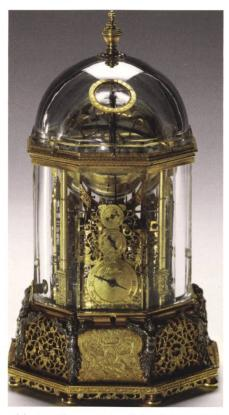
Abb. 6: Wiener Kristalluhr (1622/1627). Die vergoldete Tischuhr von Jost Bürgi enthält einen mechanischen Globus. Sie besteht aus einer Kupferlegierung, Silber und Bergkristall, das Werk ist aus Messing, © Kunsthistorisches Museum Wien/KHM-Museumsverband.
