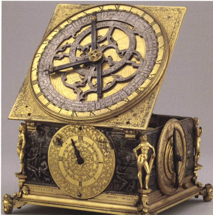
Abb. 5: Äquationsuhr mit aufgeklapptem Deckel (1591). Die komplexe astronomische Stutzuhr des Uhrmachers Jost Bürgi zeigt die Differenz zwischen den mittleren und den wahren Bewegungen von Sonne und Mond an (sogenannte Gleichung, Äquation), © Museumslandschaft Hessen Kassel, Astronomisch-physikalisches Kabinett.
