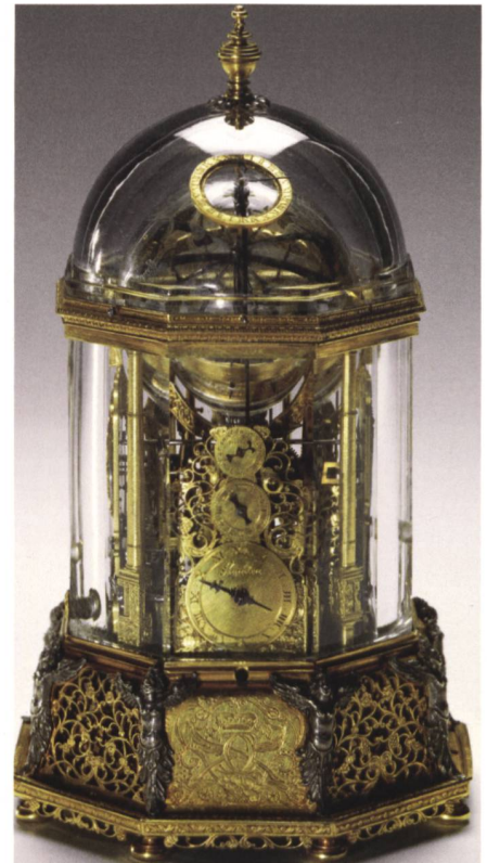
Abb. 6: Wiener Kristalluhr (1622/1627). Die vergoldete Tischuhr von Jost Bürgi enthält einen mechanischen Globus. Sie besteht aus einer Kupferlegierung, Silber und Bergkristall, das Werk ist aus Messing, © Kunsthistorisches Museum Wien/KHM-Museumsverband.
