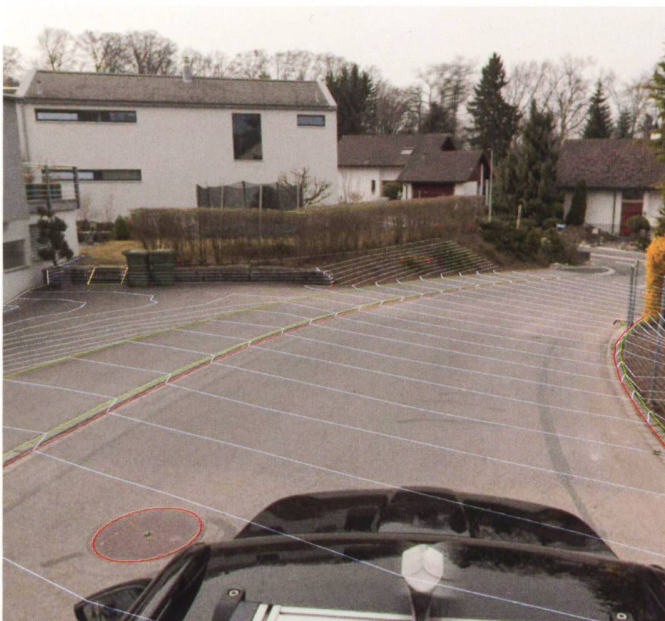
Überlagerung des ausgewerteten Geländemodells der Fahrbahn mit dem Panoramafoto des Mobile Mapping Systems MX9 der ALLNAV (Bild: geotopo ag, Frauenfeld).
