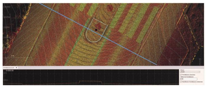
Der mittels Auswertungssoftware Trimble Business Center erstellte Schnitt von 3 cm durch die Punktwolke im Bereich einer Verkehrsinsel zeigt die hohe Genauigkeit der Punktwolke (Bild: geotopo ag, Frauenfeld).
