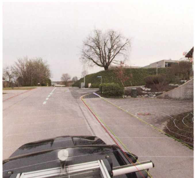
Überlagerung des ausgewerteten Geländemodells der Fahrbahn mit dem Panoramafoto des Mobile Mapping Systems MX9 der ALLNAV (Bild: geotopo ag, Frauenfeld).
