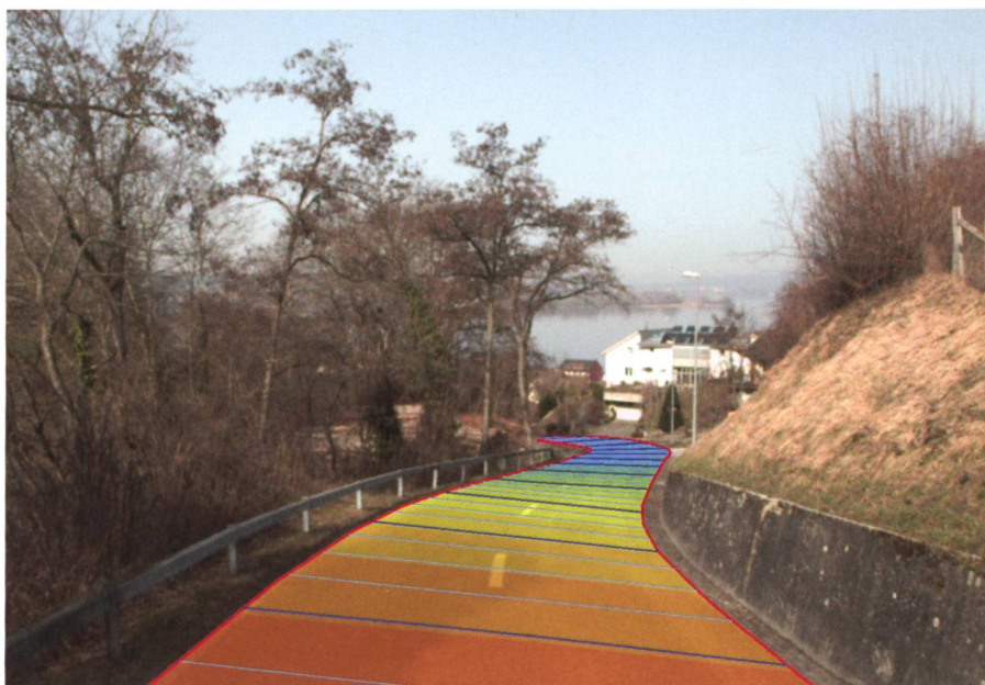
Überlagerung des ausgewerteten Geländemodells der Fahrbahn mit dem Panoramafoto des Mobile Mapping Systems MX9 der ALLNAV (Bild: geotopo ag, Frauenfeld).
