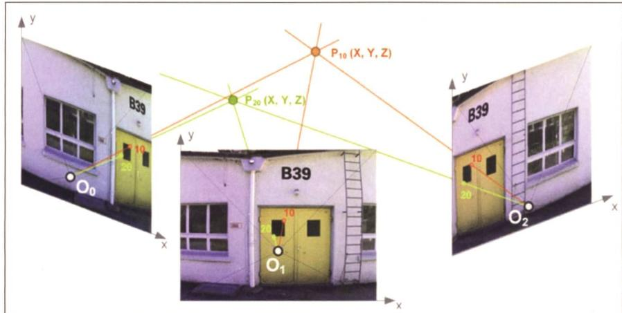
Abb. 2: Photogrammetrischer Vorwärtschnitt zur Objektpunktmessung der Punkte  $P_{10}$  und  $P_{20}$ . Quelle: Majeric (2020).
