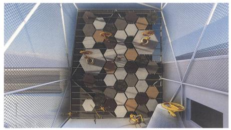
Abb. 2: Additive Fertigung: Eine Fassade mit austauschbaren Elementen und unterschiedlichen Oberflächen dient der Erforschung und Entwicklung von Inspektions- und Reparaturdrohnen.
