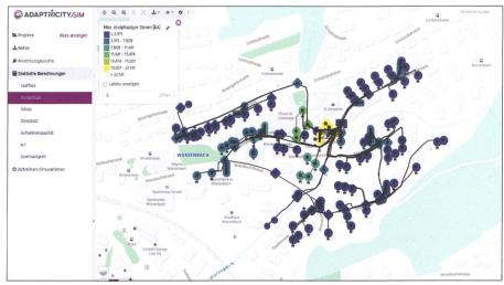
Abb. 5: Monitoring (Kurzschlussberechnung; Quelle: energie wasser luzern).
