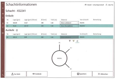
Abb. 2: Eingabe der Ein- und Ausläufe inkl. Schachtskizze.
