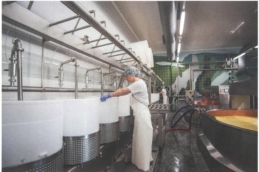
Fig. 2: Un outil de travail performant avec deux cuves de 6600 litres et une de 600 litres permettent la fabrication des différents fromages, à savoir la Tête de Moine AOP, le Gruyère AOP et les spécialités à pâtes mi-dure, le Noirmont, le Roc-Montès, le Taignon et le Franches-Montagnes.
