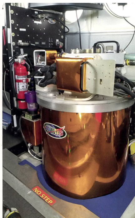
Abb. 2: AVIRIS-NG, eingebaut in der Beechcraft B200c Super King Air.
