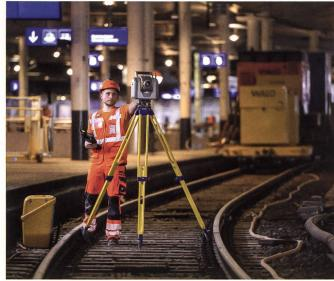
die Baugrubenwände dem Geländedruck standhalten. Zudem werden die Gleise im jeweiligen Bauabschnitt und zur Sicherheit auch zwei weitere, links und rechts des Abschnitts überwacht. Mittels Tachymetermessungen können allfällige vertikale und horizontale Verschiebungen der Schienen sowie auch der Perrondachstützen millimeterscharf festgestellt und so im Fall der Fälle umgehend die notwendigen Schutzmassnahmen ergriffen werden.
