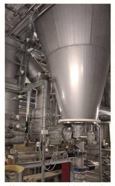
Abb. 4: Der untere Teil des Schwebebettreaktors. Hier werden Fremdstoffe (Nägel, Schrauben, Steine usw.) durch die Schwerkraft nach unten abgeschieden.
