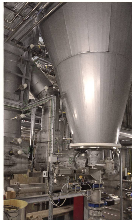
Abb. 4: Der untere Teil des Schweb- bettreaktors. Hier werden Fremdstof- fe (Nägel, Schrauben, Steine usw.) durch die Schwerkraft nach unten abgeschieden.
