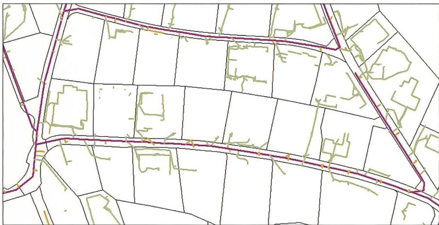
Fig. 7: Struttura della rete: verde = evacuazione acque di scarico edificio, pink = collettori, arancio = evacuazione acque di scarico strada.
