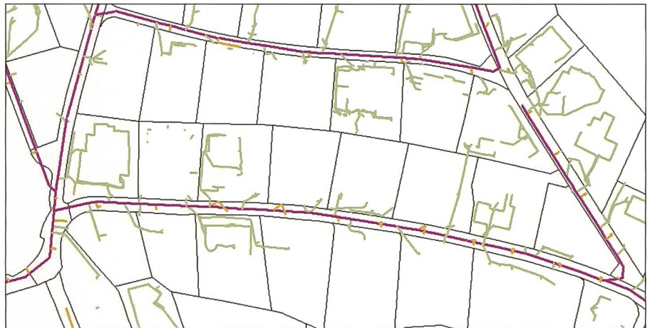
Fig. 7: Struttura della rete: verde = evacuazione acque di scarico edificio, pink = collettori, arancio = evacuazione acque di scarico strada.
