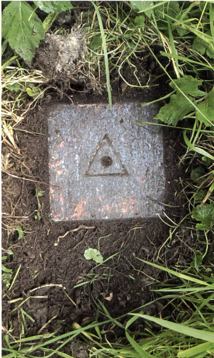
Abb. 2: Granitstein eines ehemaligen Triangulationspunktes mit eingemeissem Kreuz (heute LFP3).
