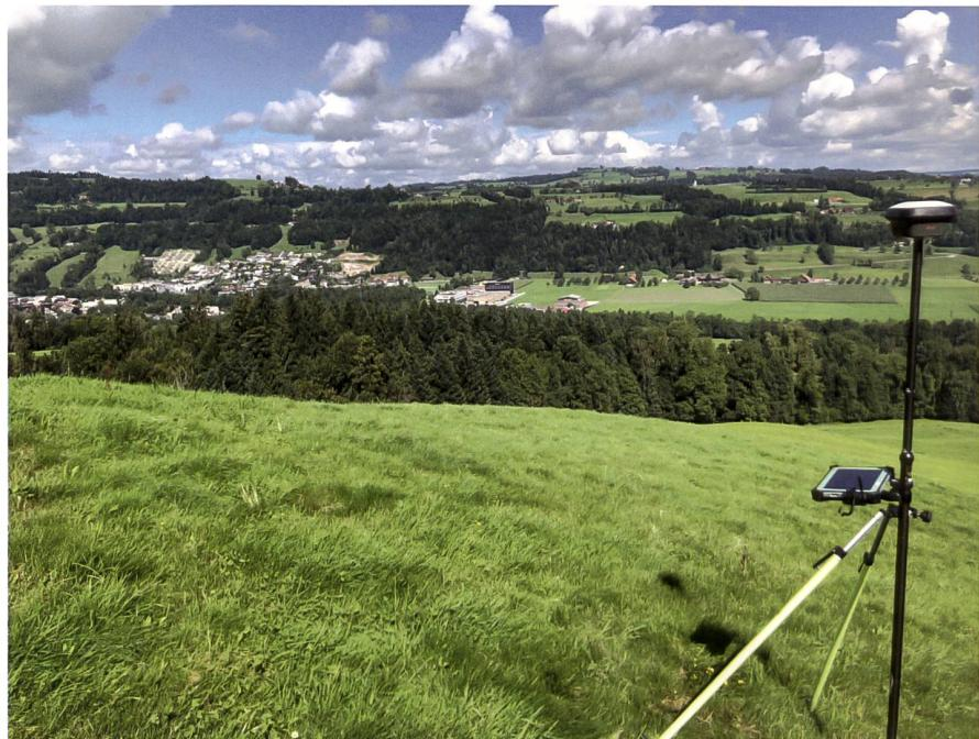
Abb. 1: Kontrollpunktmessung über dem Dorf Malters mit Leica GS18i und Tablet CS35.
