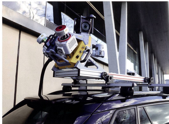
Das Trimble Mobile Mapping System MX9 erfasst Daten bis zu 400 Meter Entfernung mit einer Scangeschwindigkeit bis zu 500 Scans/Sekunde und einer Genauigkeit von bis zu 3 mm.
