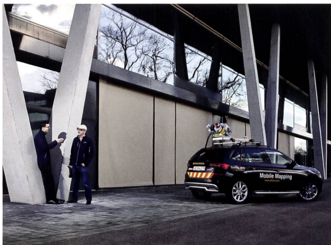
Einsatzbereit: Das Demofahrzeug der ALLNAV mit auf dem Dach montiertem Mobile Mapping System.
