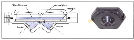
Abb. 3: Der T2000 Flüssigkeitshorizont (@ Leica Geosystems).
