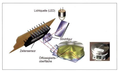
Abb. 5: Prinzip des digitalen Neigungssensors 99 (@ Leica Geosystems).
