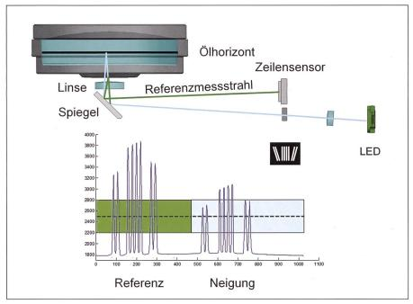
Abb. 6: Prinzip des «Belo Horizonte» Neigungssensors (@ Leica Geosystems).
