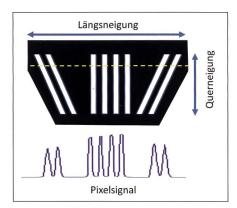
Abb. 4: Strichfigur und digitales Signal (@ Leica Geosystems).
