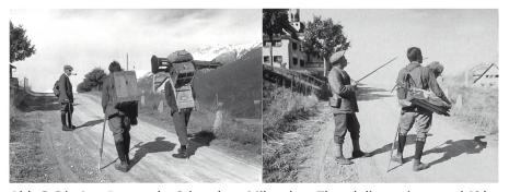
Abb. 3: Die Ausrüstung des Schrauben-Mikroskop-Theodoliten wiegt total 49 kg und muss von zwei Gehilfen getragen werden. Die Wild'sche Ausrüstung dagegen ist nur 17 kg schwer und kann von einem Mann leicht getragen werden.
