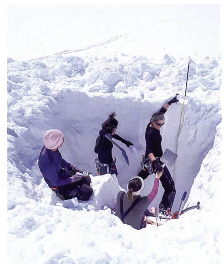
Abb. 2: Schneeschacht, 3 m tief, nahe des Jungfraujochs. Alle 20 cm wurden Schneedichte und Temperatur bestimmt. Dies ist im Vergleich zu den Bohrungen viel aufwändiger, jedoch lassen sich Schichten im Schnee besser identifizieren (Foto: M. Zemp).
