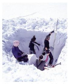
Abb. 2: Schneeschacht, 3 m tief, nahe des Jungfraujochs. Alle 20 cm wurden Schneedichte und Temperatur bestimmt. Dies ist im Vergleich zu den Bohrungen viel aufwändiger, jedoch lassen sich Schichten im Schnee besser identifizieren (Foto: M. Zemp).
