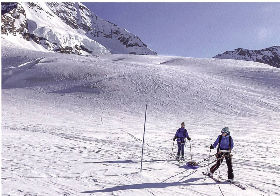
Abb. 3: Mit einem Schlitten werden die DGNSS-Antenne und das GPR über die Gletscheroberfläche gezogen. In der Mitte des Bildes ist eine Akkumulationsstange abgebildet, welche dort für andere Messzwecke permanent installiert ist (Foto: J. Schindler).
