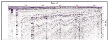
Abb. 5: Das GPR-Profil zeigt individuelle Reflektoren (≜ Schneeschichten mit unterschiedlichen Dichten) in der Schneedecke im Akkumulationsgebiet des Grossen Aletschgletschers. Die roten Quadrate stehen für Orte, wo Schneedichtemessungen gemacht wurden.
