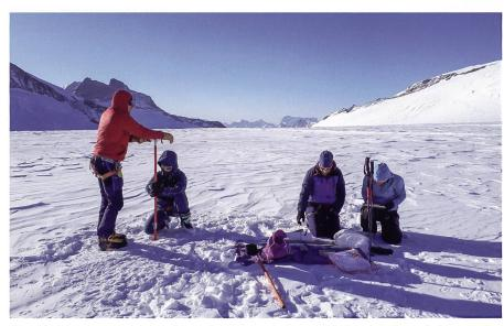
Abb. 1: Bohrung und Analyse eines Schneekerns bis 9 m Tiefe auf dem Ewigschneefeld. Alle 20 cm wurden Schneedichte und Temperatur bestimmt (Foto: M. Zemp).
