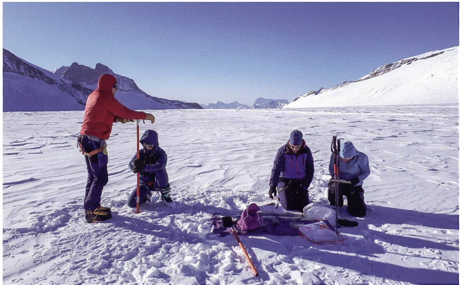
Abb. 1: Bohrung und Analyse eines Schneekerns bis 9 m Tiefe auf dem Ewigschneefeld. Alle 20 cm wurden Schneedichte und Temperatur bestimmt (Foto: M. Zemp).
