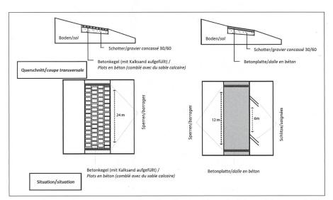
Fig. 1: Schéma de construction des chemins en plots de béton (a) et en dalles de béton (b).
