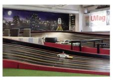
Abb. 1: Tracking eines Slotracing-Rennwagens mit einer Leica Multistation MS60 (Wolf, 2020).
