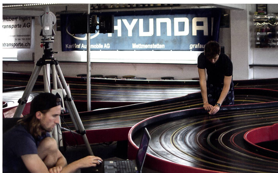
Abb. 3: Hochgenaue Vermessung der Bahn mit dem Leica Absolute Tracker AT401 (Wolf, 2020).
