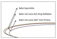
Abb. 6: Übersicht verkürzte Bahnlängen in den Steilwandkurven.
