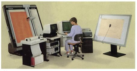
Abb. 13: Das GEOMAP-System. Der linke Bildschirm dient der alphanumerischen Ein- und Ausgabe (mit drei Diskettenlaufwerken darunter für Programme und Daten) und der rechte Schirm der Darstellung der Graphik. Rechts davon ein Gerät für den Druck von Bildschirminhalten und der Digitalisierungstisch.
