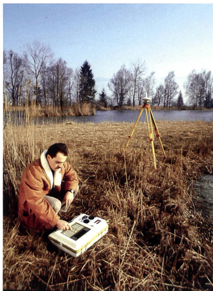
Abb. 14: Das GPS-Vermessungssystem WM101 «ist eine leicht transportable Ausrüstung von nur 14,5 Kilogramm» – wie es 1984 in der Werbung hiess.
