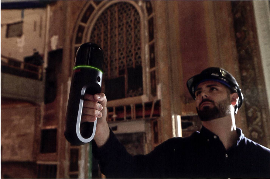
Abb. 17: Der tragbare bildgebende Laserscanner BLK2GO digitalisiert Räume in 3D, während man sich bewegt.
