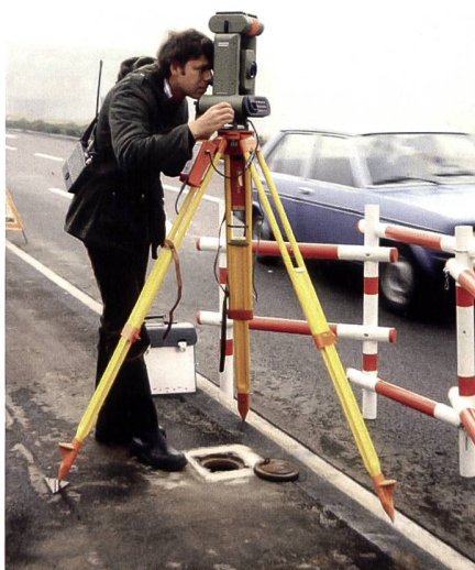
Abb. 12: Der Wild TC1 ist ein vollautomatischer Tachymeter mit Kompaktkassettengerät als digitalen Datenspeicher.
