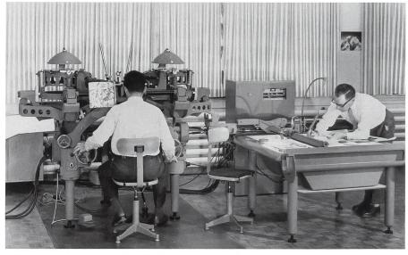
Abb. 10: Der Autograph A8 mit Zeichentisch und elektrischem Koordinaten-Registriergerät Wild EK3.
