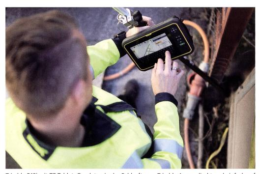
Trimble R12i mit T7 Tablet: Geodaten in der Feldsoftware Trimble Access direkt und einfach auf dem grossen und hellen Display visualisieren und nutzen (Foto: Technische Betriebe Glarus).
