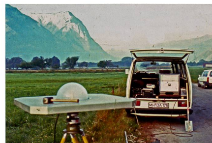
Abb. 1: Erster geodätischer GPS-Empfänger Macrometer V-1000 im 3D-Testnetz Turtmann 1985. Im Vordergrund: Antenne; Empfänger und Stromversorgung im Fahrzeug (Foto swisstopo).
