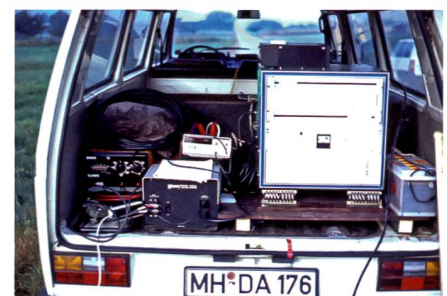
Fig. 1: Premier récepteur GPS géodésique Macrometer V-1000 avec alimentation électrique dans le bus Volkswagen. Utilisation dans le réseau test (3D) de Tourtemagne en 1985 (photo swisstopo).
