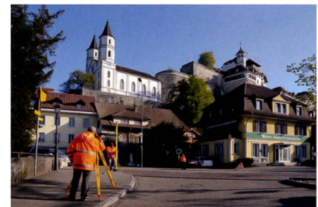
Fig.5: Réseau altimétrique national: observations à Aarburg lors du nivellement fédéral de 2016, ligne Aarburg – Berne (photo swisstopo).
