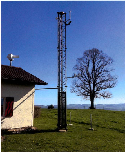
Abb. 3: Geostation Zimmerwald: Antennenmast der permanenten GNSS-Station des AGNES-Netztes, auf dem Fundamentalpunkt der LV (Foto swisstopo).
