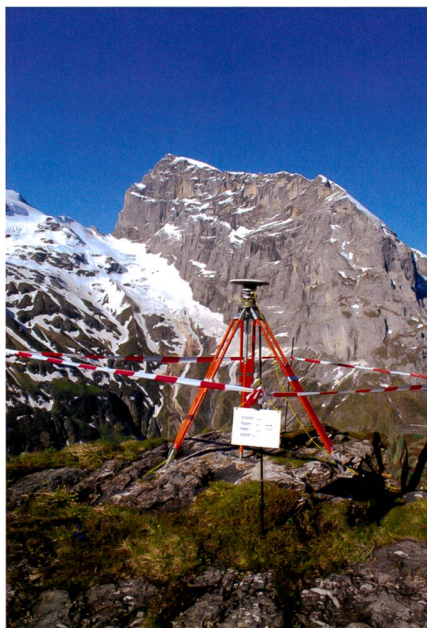
Fig. 2: Réseau GNSS national MN95. Récepteur en station sur le point principal «Engelberg» (Titlis), campagne de mesure CHTRF2010 (photo swisstopo).
