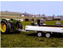
Abb. 1: Eine neuartige Apparatur soll die Bodenprofilaufnahme leichter machen. Aus dem Boden gezogene Bohrkerne können innerhalb einer Minute gescannt werden. Dies liefert wertvolle Informationen zum Bodenprofil am jeweiligen Standort.
