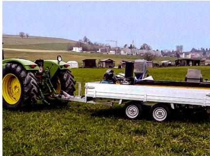
Abb. 1: Eine neuartige Apparatur soll die Bodenprofilaufnahme leichter machen. Aus dem Boden gezogene Bohrkerne können innerhalb einer Minute gescannt werden. Dies liefert wertvolle Informationen zum Bodenprofil am jeweiligen Standort.
