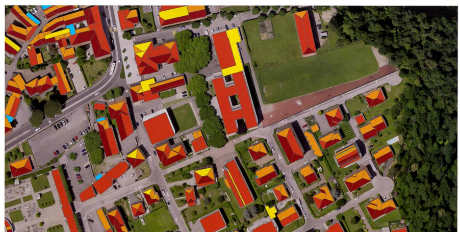
Fig. 5: Carte de l'aptitude des toitures à utiliser l'énergie solaire dans un quartier de Balerno (TI), www.toitsolaire.ch
