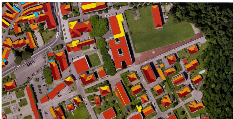
Fig. 5: Carte de l'aptitude des toitures à utiliser l'énergie solaire dans un quartier de Balerno (TI), www.toitsolaire.ch
