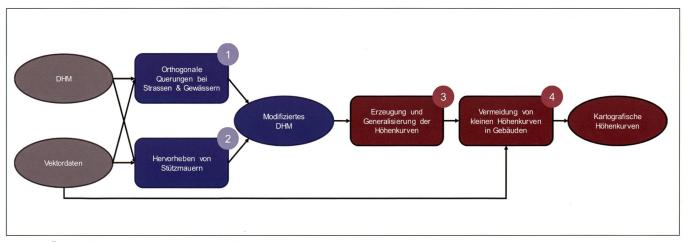
Abb. 2: Übersicht über den Prozess zur Erzeugung kartografischer Höhenkurven.
