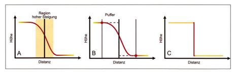
Abb. 4: Prinzip zum Hervorheben von Stützmauern und anderen steilen Objekten in Profilansicht. A: Für Bereiche im DHM mit hoher Steigung werden die Mittelachsen berechnet. B: In konstantem Abstand von den Mittelachsen werden die Höhenwerte des DHMs abgegriffen. C: Die abgetasteten Höhen werden zu beiden Seiten der Mittelachse dem DHM zugewiesen, sodass eine Verwerfung entsteht.
