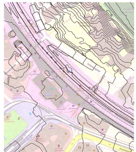
Abb. 6: Bahnhof Stadelhofen: Höhenkurven anhand der naiven Anwendung des Werkzeugs «Contour» von ArcMap auf das DHM 2019 (links). Neue Höhenkurven, die mit dem beschriebenen Prozess erzeugt werden (rechts). Massstab: 1:750. Basemap: © OpenStreetMap contributors.
