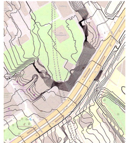
Abb. 5: Ausschnitt Rämistrasse: Höhenkurven anhand der «naiven» Anwendung des Werkzeugs «Contour» von ArcMap auf das DHM 2019 (links). Neue Höhenkurven, die mit dem beschriebenen Prozess erzeugt werden (rechts). Massstab: 1:750. Basemap: © OpenStreetMap contributors.
