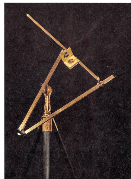
Abb. 5: Das Triangulationsinstrument Jost Bürgis hatte ein Kaiserliches Patent-Privileg. Eine umfassende Anwendungsbroschüre zeigte die Einsatzgebiete dieser berührungslosen Distanz- und Höhenmesstechnik auf.
