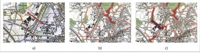
Abb. 3: Möglicher Einfluss einer Fussgängerbrücke über eine Bahnlinie und den Ausbau eines Fusswegs durch das Industriequartier bei Wil SG auf die Fussgängerströme (a); (b) ohne bauliche Massnahmen; (c) mit baulichen Massnahmen. Je dunkler die Farbe einer Wegstrecke, umso häufiger wird die Strecke von den modellierten Agenten benutzt.
