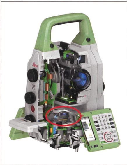
Abb. 7: Schnittmodell ScanStation mit Flüssigkeitskompensator.
