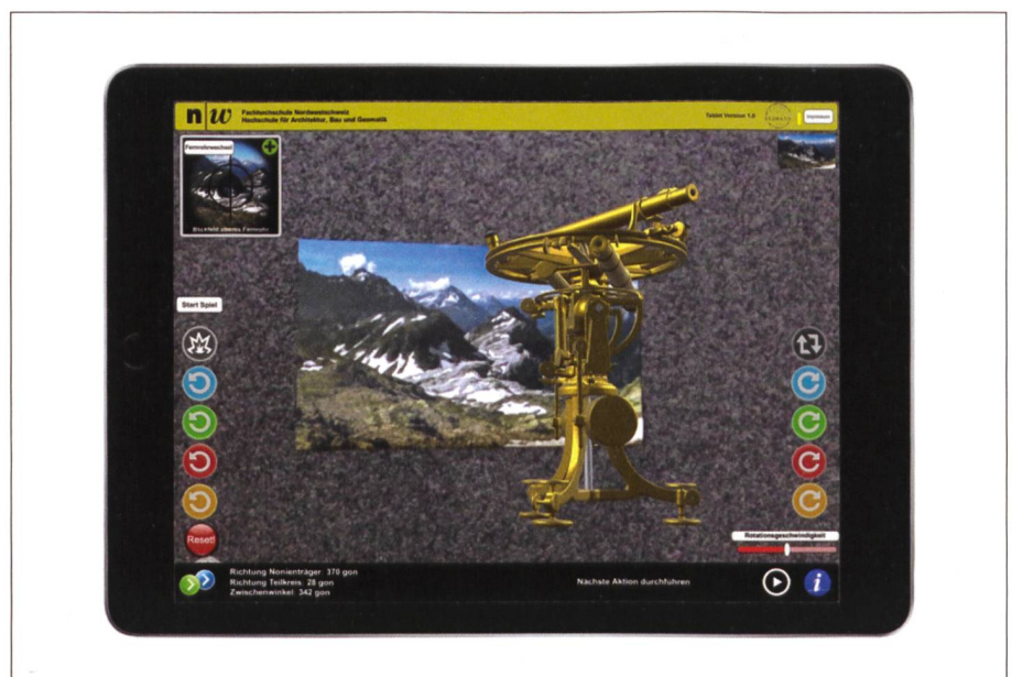
Abb. 4: Die Tablet-App zeigt den Borda-Kreis vor einem Panorama-Image Target. Mit den verschiedenen Knöpfen können die verschiedenen Komponenten des Borda-Kreises einzeln rotiert werden (Berchtold & Pünter, 2018).
